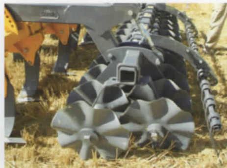
作業幅4mの大型折畳スピードプラウ！ 移動時は、3m幅になります。
