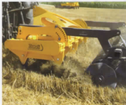
作業幅4mの大型折畳スピードプラウ！ 移動時は、3m幅になります。
