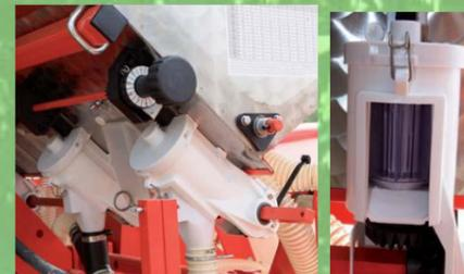
希望の施肥量に応じて目盛りを合わせるだけで、簡単にそして正確な施肥量が調節できます。これはガスパルド社が特許を持つ、世界に誇る高精度の肥料用計量器です。
