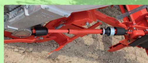
チェーンが無いので、注油が不要で摩耗や伸びによるメンテナンスの必要がありません。圃場端での作業時に、播種が重複しないように播種部への駆動を簡単に手で止めることもできます。
