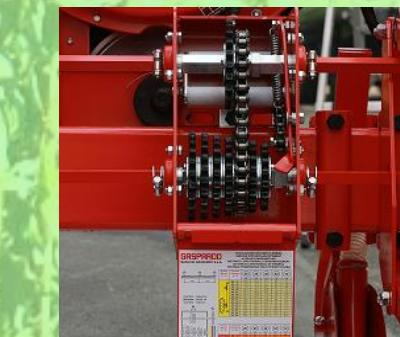
確実な収量を得るために播種間隔を正確に選択することが大切です。ギヤの組み換えで工具を使わずに簡単に播種間隔を調整できます。
