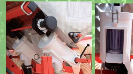
希望の施肥量に応じて目盛りを合わせるだけで、簡単に正確な施肥量が調節できます。これはガスパルド社が特許を持つ、世界に誇る高精度の肥料用計量器です。
