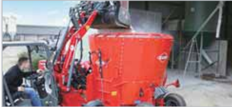
積み込みの高さは470が2.08m、670が2.33mとなります。餌の積み込み作業が容易に行えます。
