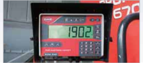
【KDW340計量器】 シンプルな計量とプログラム可能な計量が選択可能。
