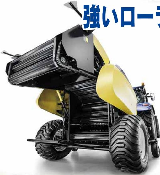
新型ロールベラー125には新しい表面形状を持つ高強度の冷間成形ローラーが18本装備されており、ベールの回転を促し、ロスを減らして高密度のベールを確実に作成します。ローラー表面には溶接箇所がなくベールチャンバー内を作物がスムーズに通過し、ラッピング中にネットやフィルムが破損するのを防ぎます。
