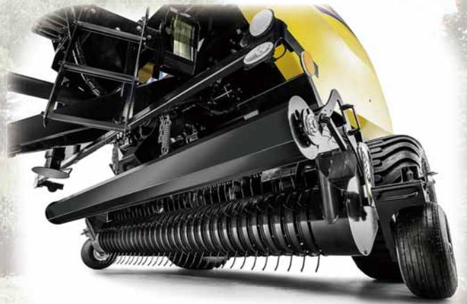
ニューホランドビッグベラーやロールベルトベラーモデルの主要なコンポーネントを使いながら、最新のロールベラー125は大きな2.3m幅のピックアップを備えています。ビッグベラーレンジから改良されたローラーの風よけを装備し、取り外し可能な固定式またはスイベル式ホイールが選択でき、移動時はピックアップに収容できます。
