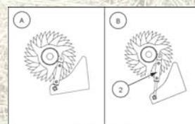
大きく開くドロップフロアが装備されるようになりました。トラクターキャブから作動させるとドロップフロアは独自の旋回デザインでフロント側が120mm、リヤは60mm下がります。ローターのクラッチ切断機能を使用すれば、深刻な詰まりが発生した時に油圧でローターおよびピックアップの駆動を解除できます。これら2つのシステムが組み合わさって、詰まりによるダウンタイムを最小限に減らし、厳しい条件下でも生産的でいられるよう、あなたのお役に立ちます。
