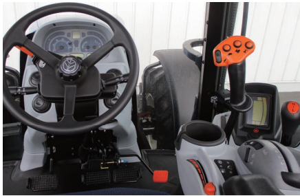
ステアリングハンドル回りと右前コンソールにまとめられた運転操作装置
