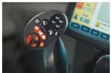
ソフトタッチボタンにはバックライト機能が組み込まれており、暗い中でもより簡単に制御を選びます。
