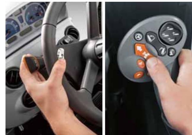
自動圃場モードはエンジン回転数とトランスマッisionの両方を管理して、PTOと牽引作業の性能及び経済性を最適化します。
