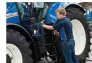
48リットルのAdBlue®タンクのフィラーネックは標準の燃料タンクのものよりも狭くなっています。誤って燃料を充填してしまうのを防ぎます。AdBlue®タンクの充填は燃料タンクの充填2回につき1回しか必要ありません。
