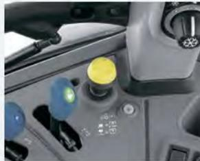
ソフトスタートPTOにより、作業機とトラクターを保護することができます。オートPTOは、枕地旋回時にPTOを自動的に解除、作動させオペレーターの手間を省きます。
