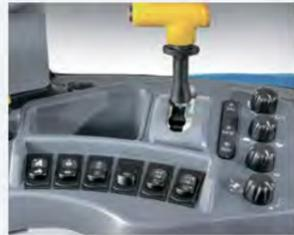
全てのスイッチにバックライトが付いており、夜遅くまで作業する際に操作がよりしやすくなります。バックライトは、作業灯を作動させると自動的に点灯します。
