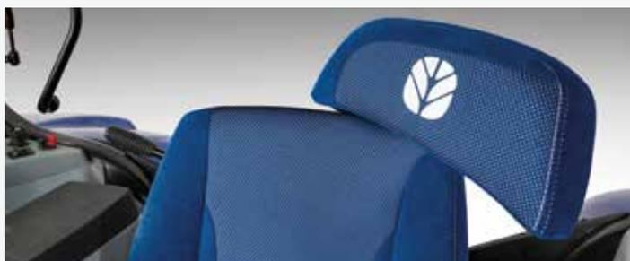
コンフォート/ダイナミックコンフォート™シートには革新的なスイベル式バックレスト機能があります。リヤの作業機を確認する時に便利です。
