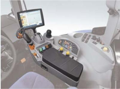
ニューホランド純正の自動操舵「インテリスティア」はトラクターのシステムに完全に統合されています。余分な配線が一切見えないスタイリッシュな内装はトラクター統合型システムだからこそ実現ができました。
