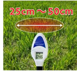
計測範囲は作物との距離によって変動し、60cmの高さで計測すると幅25cm、120cmの時は50cm幅を計測します
