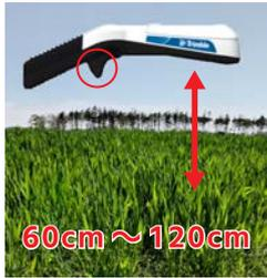
計測したい場所で作物から60～120cmの高さで計測ボタンを押します
