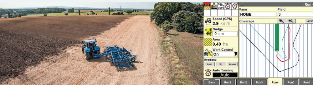
枕地の自動旋回機能「インテリターン」は、ハンズフリーで次の畝に一発で入ることが可能です。入る畝は隣だけでなく、1本2本飛ばしなど、自由に設定できますので、切り返しが不要となり作業効率を飛躍的に高めます。
